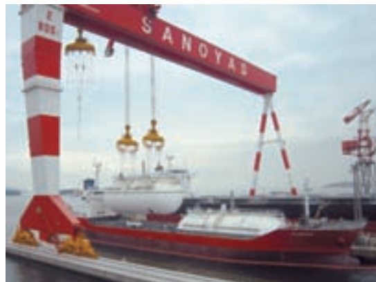
村上秀造船向け「7,500㎡LPGタンク」 水島製造所にて搭載
