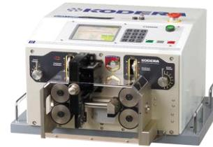
全自動電線切断皮剥装置
