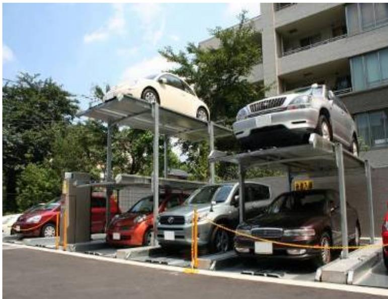
ピット昇降式駐車装置（地下2段・地上1段）
